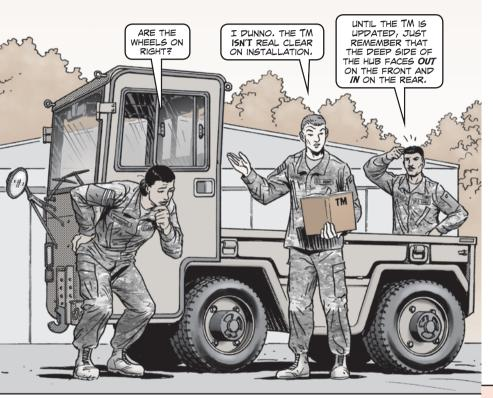
WP 0091 OF TM 1-1740-221-13&P TELLS YOU TO POSITION THE WHEEL ASSEMBLY ON THE STUPS. WHAT IT DOESN'T SAY IS THAT THE FRONT WHEELS SHOULD BE INSTALLED BE INSTALLED BY A SHOULD BE A SHOULD SHOULD BY THE STUDY.
